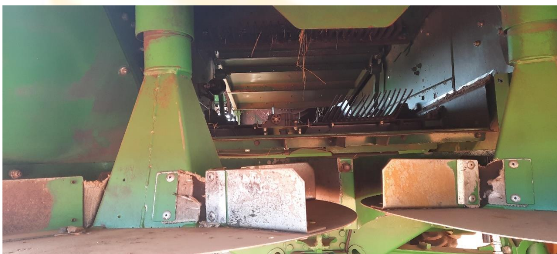
Pela traseira da máquina observa-se o sistema para espalhar a palha e separação.
